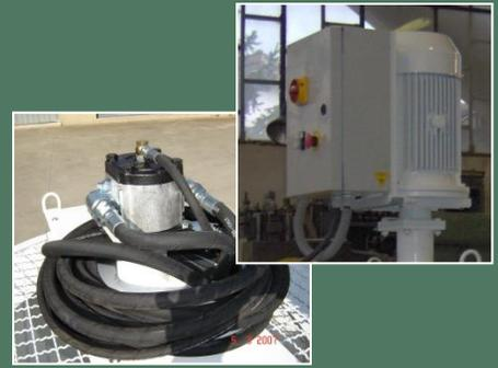
Motore idraulico da 7,5 Kw con tubi idraulici in dotazione
